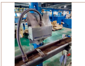
(7) 发泡挤塑绝缘(测量电容)
